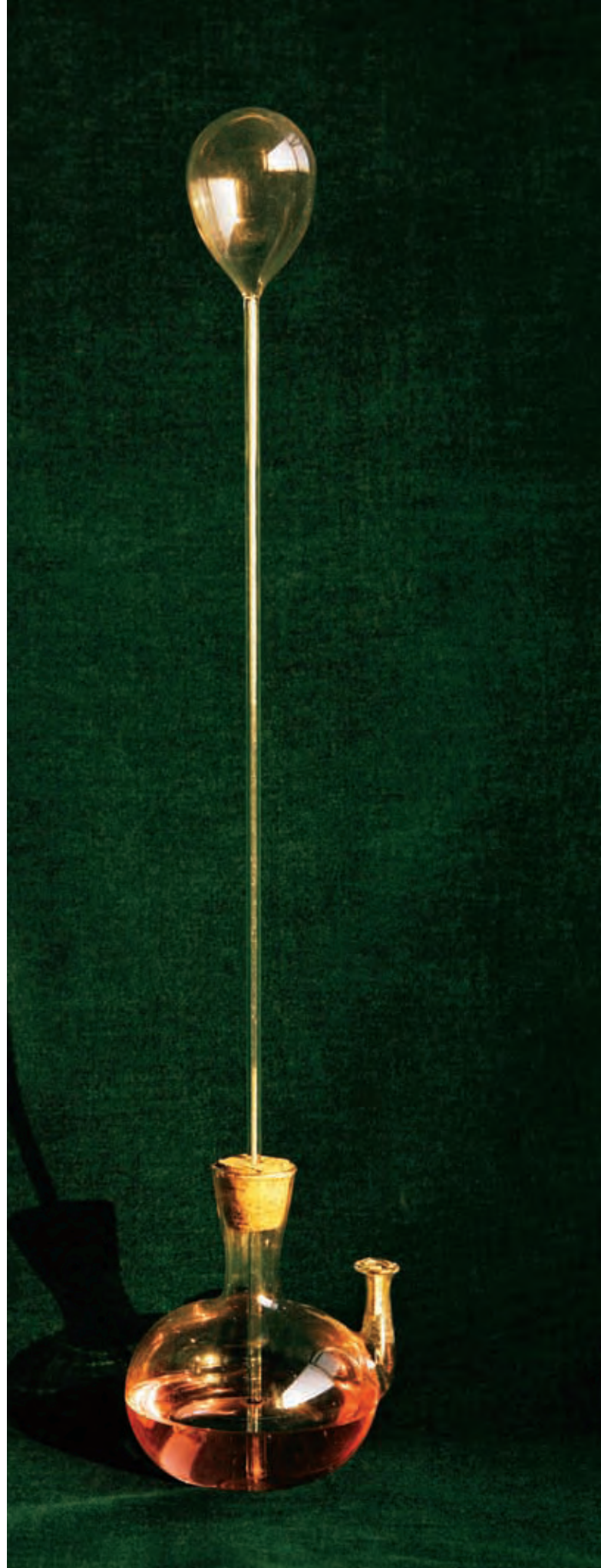
Termoscopio inventado por Galileo Galilei.
