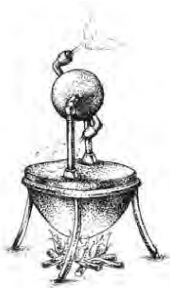
Aelopila. Dispositivo que genera movimiento con la fuerza del vapor.
