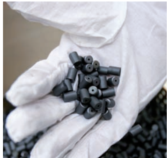
♦ Pellets de dióxido de uranio, usados como combustible para reactores nucleares.
